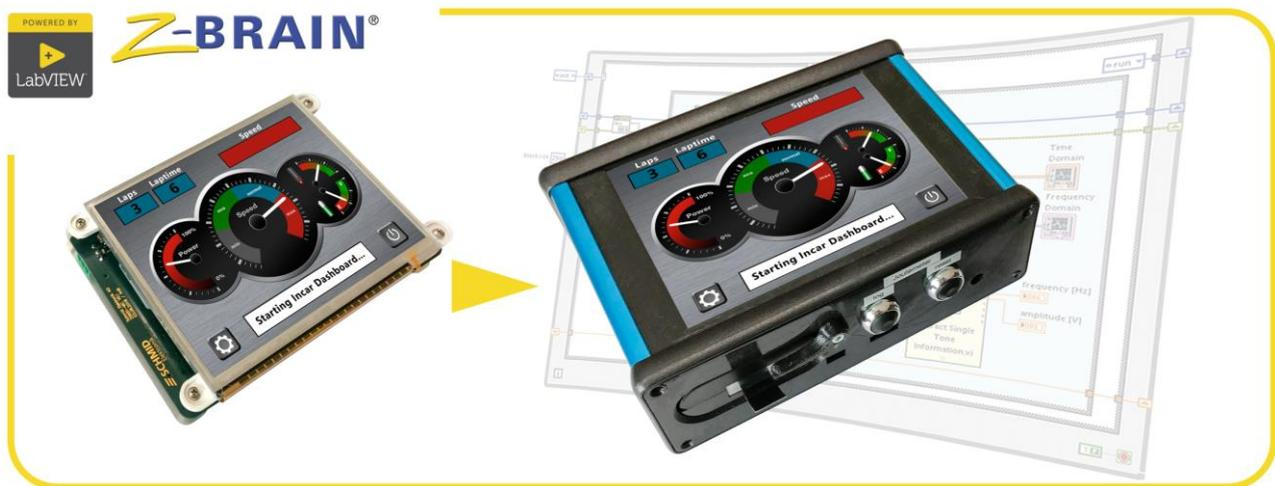
Bild 12 | Das MVP eines Dashboards fürs Cockpit liefert dem Rennfahrer live Telemetriedaten. Dank hoher Abstraktion der grafisch programmierbaren ZSOM-Control-Hardware mit Display sind sogar während dem hektischen Rennalltag Programmierarbeiten und damit schnelle Build-Measure-Learn-Zyklen möglich.
